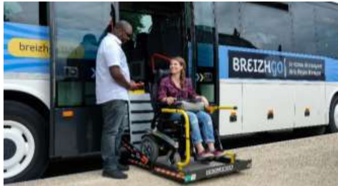
Autocar équipé d'un hayon élévateur
